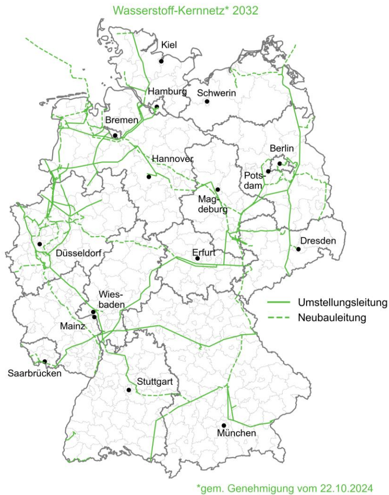
Abbildung 14: Genehmigte Planung für Wasserstoff-Kernnetz [Quelle: FNB Gas 2024]
